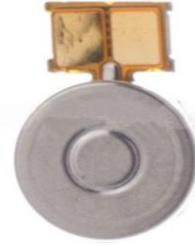
Fig. 6. Xiaomi-mi-mix-2 vibration motor
